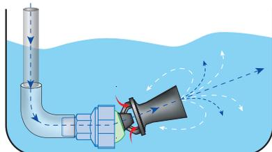
ZLF螺牙式球形噴嘴底座，除了可以安裝球形噴嘴外，也經常與UPB系列槽底攪拌噴嘴搭配使用，提供最佳的液體攪拌效果。
